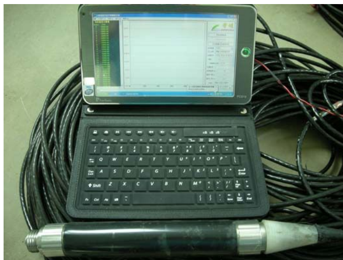
图 5.2-7 三维流速矢量测量仪
